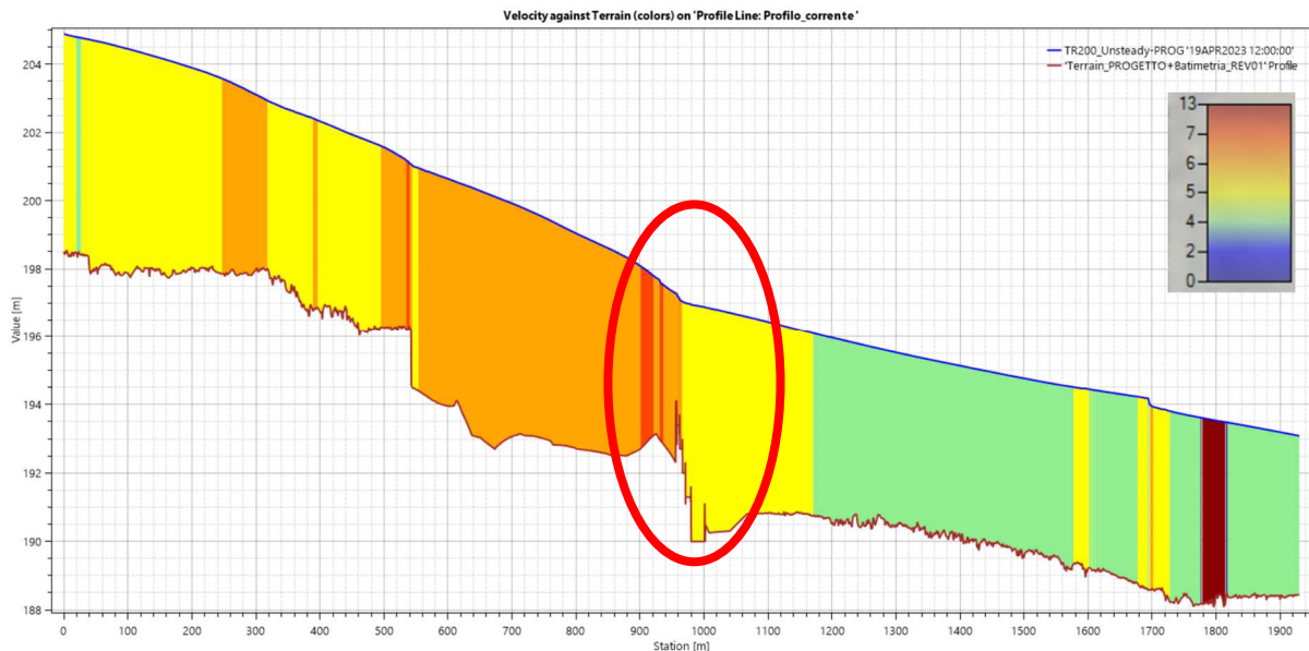
Figura 5-25. Risultato modello stato di progetto T_R 200 anni. Profilo longitudinale dell'altezza idrica (m s.l.m.) con rappresentazione colorata delle velocità sui tratti (m/s).
