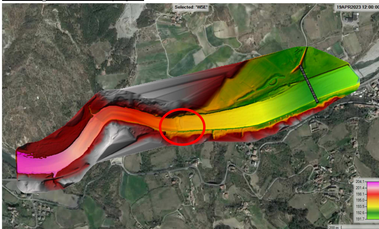
Figura 5-19. Risultato modello stato di progetto T_R 20 anni. Planimetria rappresentante l'altezza idrica (m s.l.m.)
