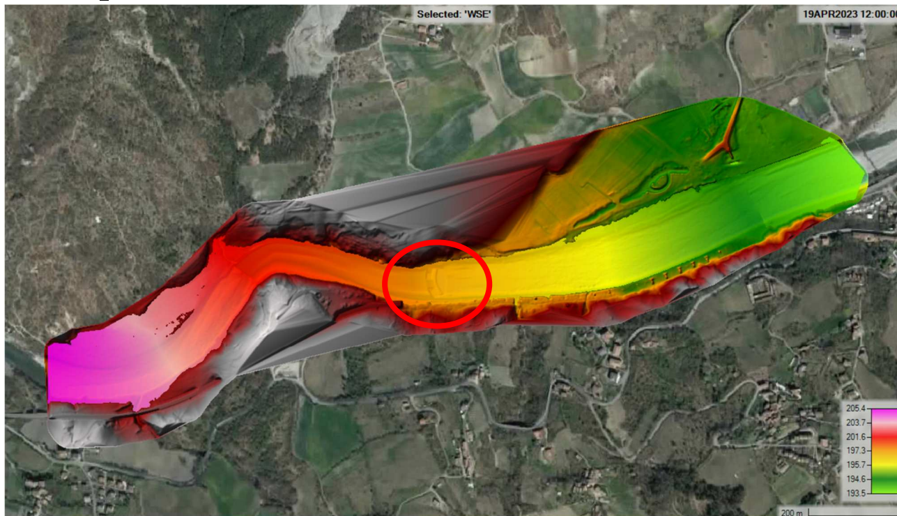
Figura 5-12. Risultato modello T_R 500 anni. Planimetria rappresentante l'altezza idrica (m s.l.m.).
